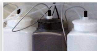
Continuo monitoraggio dei reagenti tramite sonde di livello. Il Reagente DPD in polvere da diluire prima dell'utilizzo è una ottima soluzione per conservare il prodotto in sicurezza in ogni luogo
